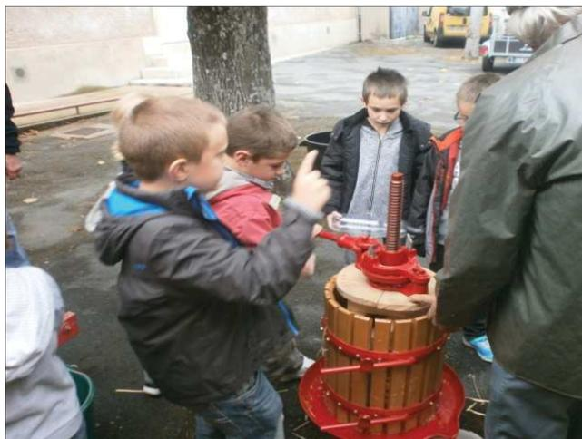
Au début on a mis des pommes dans une machine : un broyeur. On a obtenu de la purée de pommes. Puis on a versé cette purée dans le pressoir. Par-dessus, Dédé a mis de la paille et des morceaux de bois. En bougeant la manivelle, les bois aplatissaient la purée.
