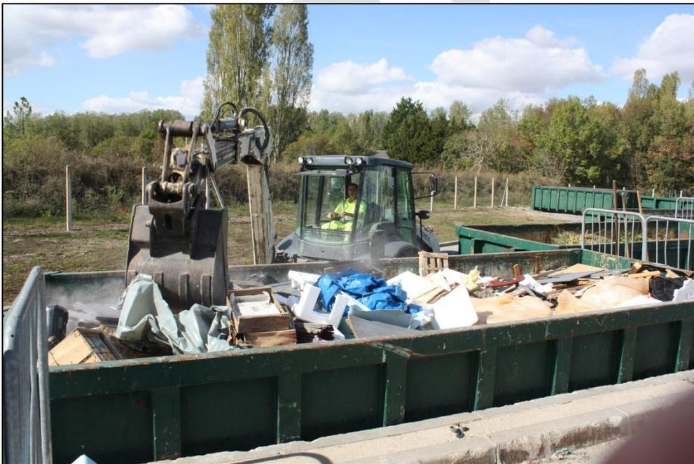
*Opération de tassage de benne réalisée avec le tractopelle*
