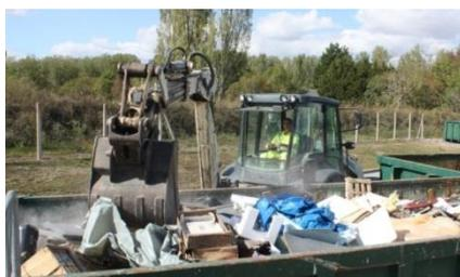
Le tractopelle permet l'optimisation des rotations par un compactage efficace des déchets. Le poids moyen des bennes peut ainsi être doublé.
